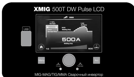
2. Выбор пункта на параметрической кривой: нажимайте регулятор 1 (Рис. 6.1) до выбора нужного пункта..
