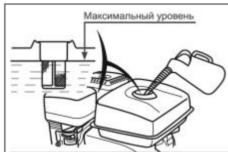
Рис. 13 Максимальный уровень топлива в топливном баке
